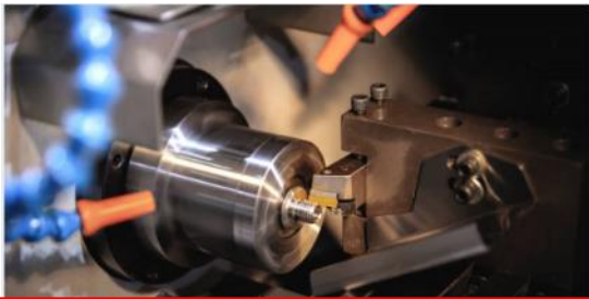
加工 (シリンダ部分の切削)
